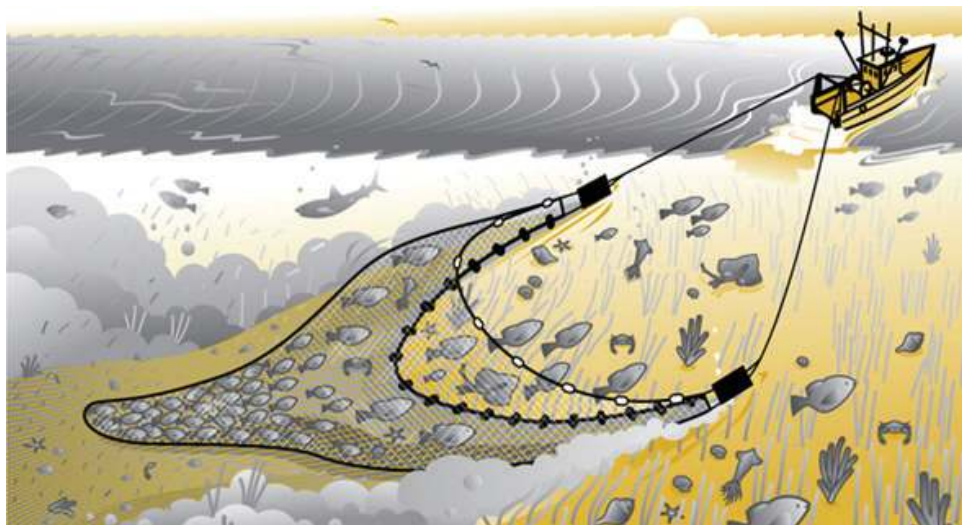
Gambar 5.6 Pengoperasian trawl (pukat harimau).
