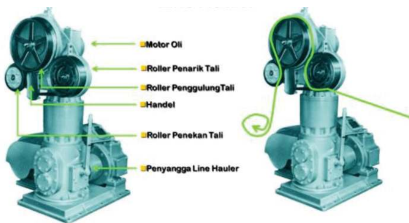
Gambar 2.7 Line hauler sebagai alat bantu penangkapan longline
