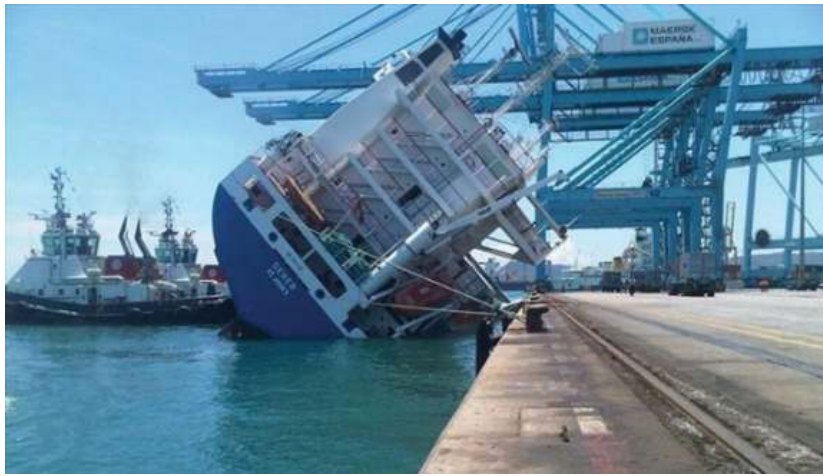
Gambar 7.11 Kapal terbalik akibat stabilitas yang tidak sesuai.
