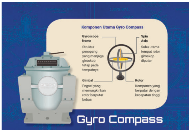
Gambar 10.10 Komponen Utama Kompas Listrik (Gyro Compass)
