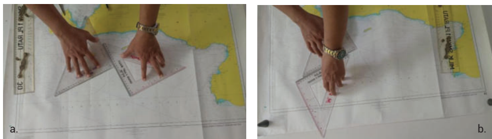
Gambar 8.5 Penentuan Garis Haluan/Baringan pada Peta Laut Menggunakan Sepasang Penggaris Segitiga Siku-Siku (a) Pengukuran pada Garis Haluan/Baringan, (b) Digeserkan ke Mawar Pedoman Sumber: Rokmami (2024)
