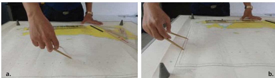
Gambar 8.3 Pengukuran Jarak pada Peta Laut (a) Pengukuran Jarak Dua Buah Titik, (b) Dijangkakan Langsung ke Lintang Kanan Peta Sumber: Rokmami (2024)
