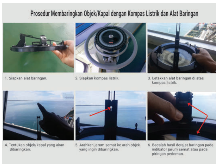
Gambar 10.11 Prosedur Membaring Objek/Kapal dengan Kompas Listrik
