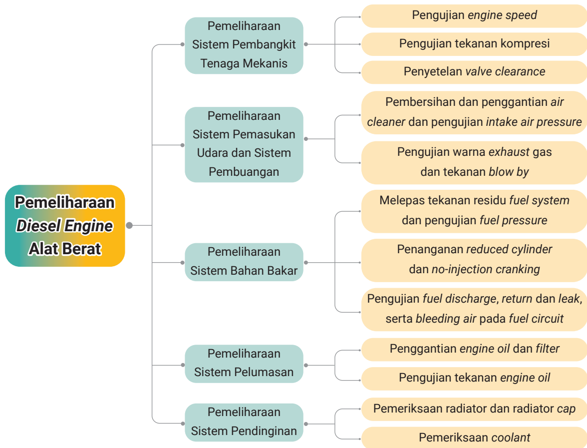
Gambar 1.1 Peta Materi Pemeliharaan Diesel Engine Alat Berat
