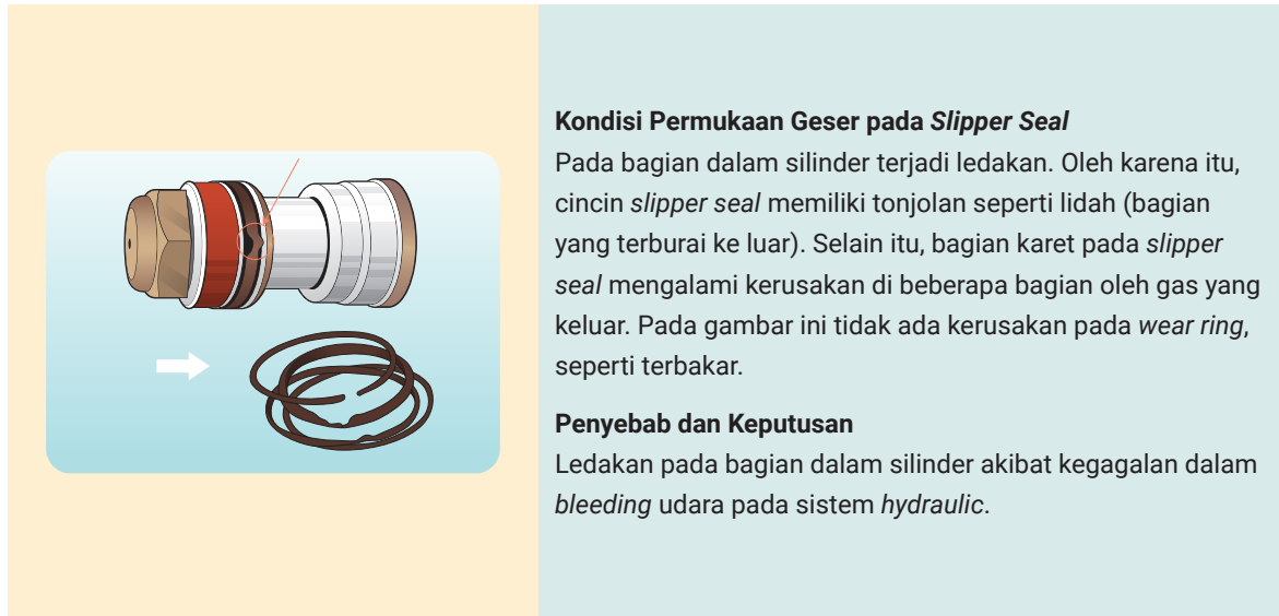
Gambar 2.3 Contoh kerusakan slipper seal pada hydraulic silinder.
