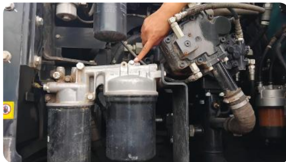
Gambar 1.13 Pickup Plug pada Fuel Main Filter
