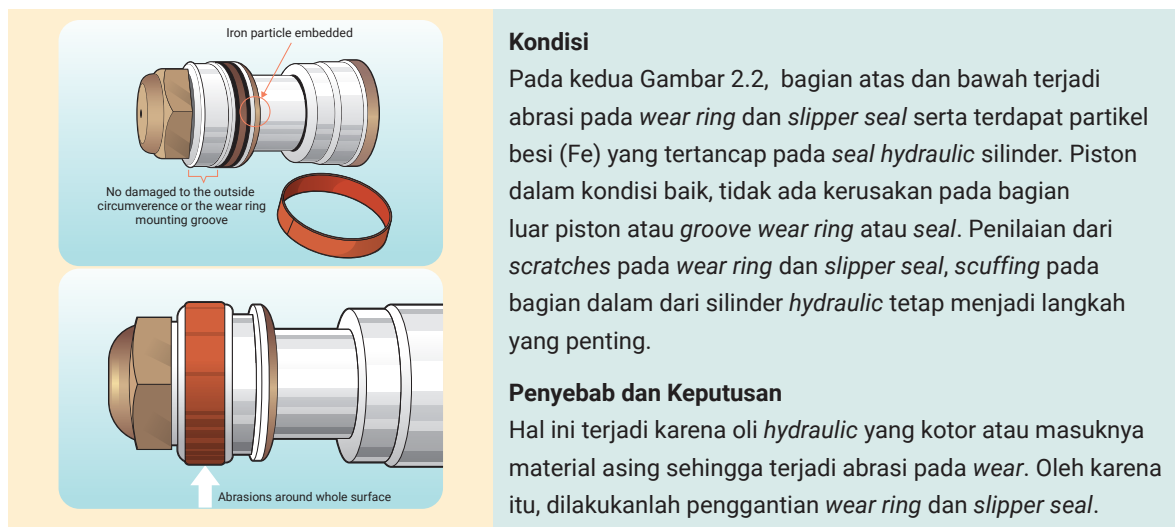
Gambar 2.2 Contoh kerusakan wear ring dan slipper seal pada hydraulic silinder.
