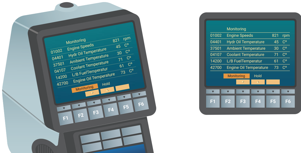
Gambar 1.2 Contoh pembacaan low idle speed di layar monitor PC 2000-8.
