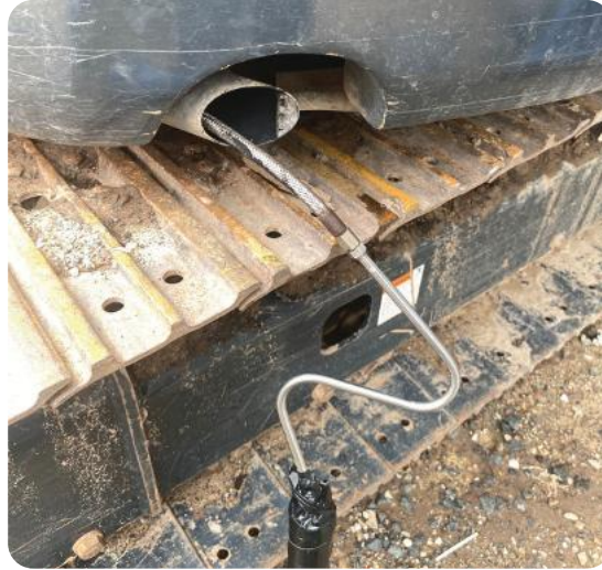
Gambar 1.11 Memasukan probe ke outlet pipa exhaust
