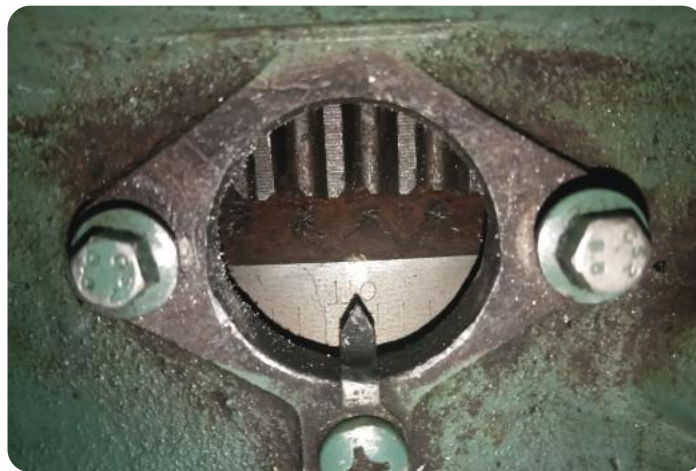
Gambar 1.5 Tanda Garis pada Flywheel Housing PC 45MR-3
