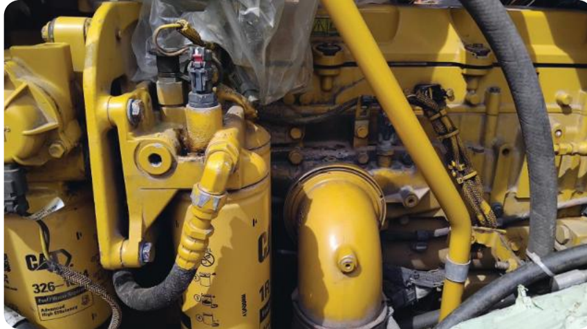
Gambar 1.10 Posisi pickup plug pada body intake .
