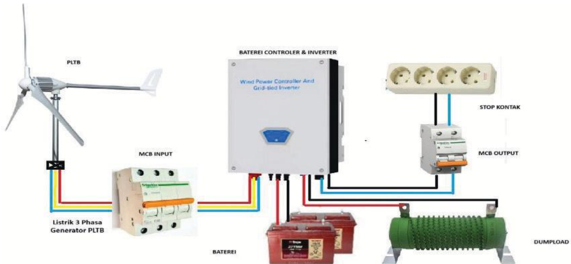
Gambar 3.9 Sistem Kelistrikan PLTB Skala Kecil Sumber: Amin Wahyono/Kemendikdasmen (2025)
