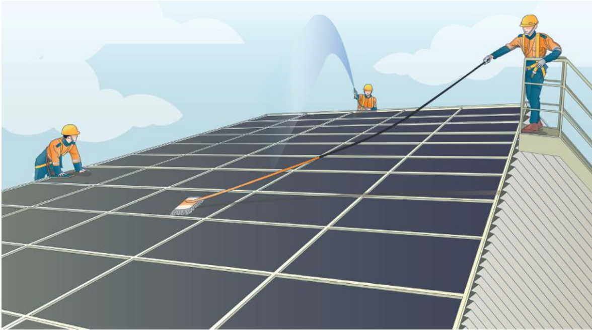
Gambar 1.16 Perawatan Modul Surya Sumber: Kemendikdasmen (2025)
