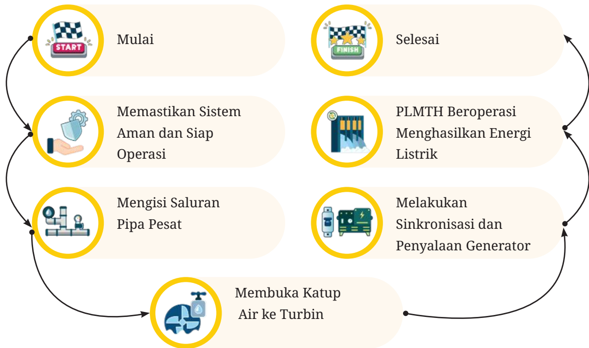
Gambar 2.13 Diagram Alir Menyalakan ( Turn On ) PLTMH
